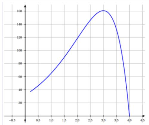
Graphiquement on peut lire que la puissance maximale atteinte par le rameur est de 160 Watts et qu'il développe une puissance supérieure à 100 Watts pendant un peu plus de 2 dixièmes de seconde.
